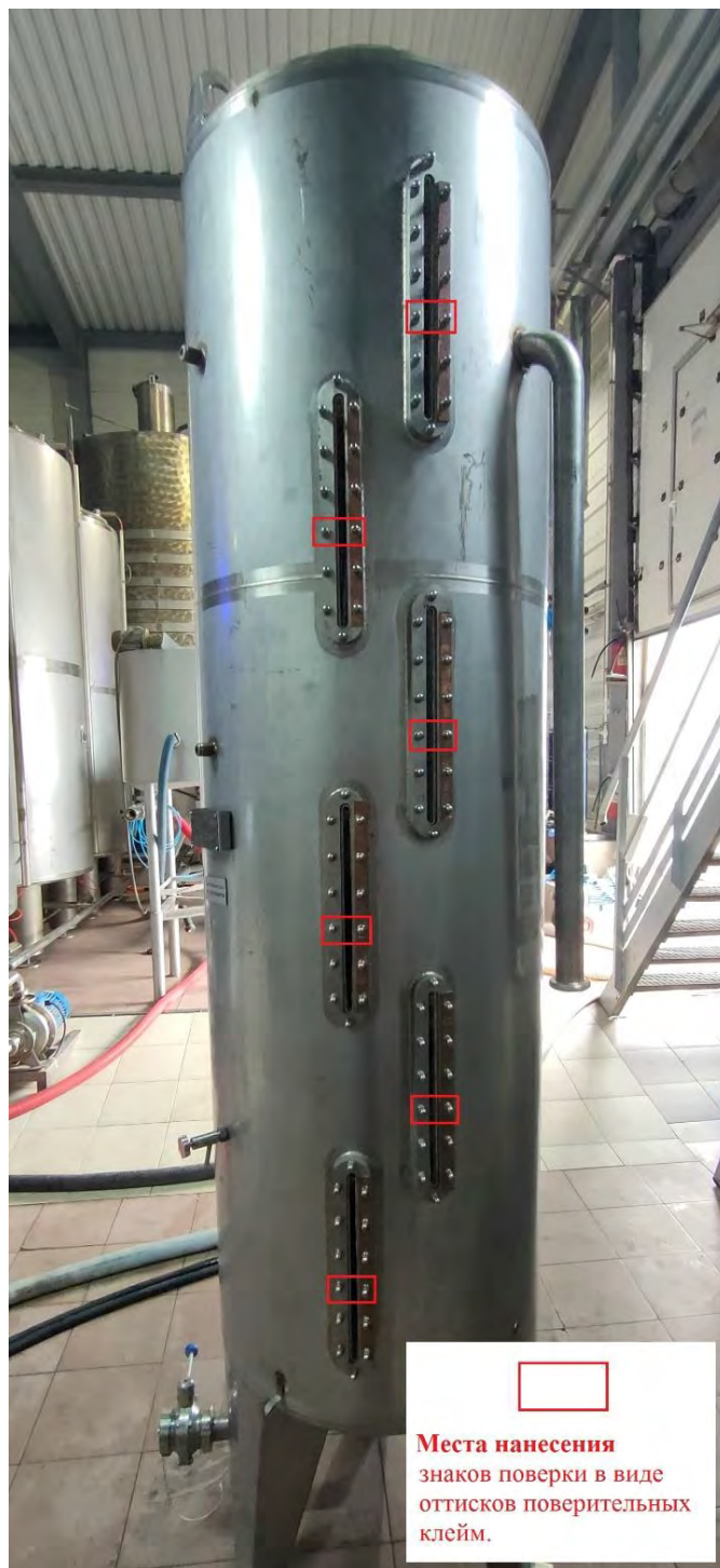
Рисунок 2 – Схема пломбировки мерника 1 класса V=0,75 \text{ м}^3 заводской № 5166.070 от несанкционированного доступа, обозначение места нанесения знака поверки
